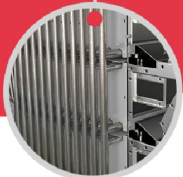
Il vapore surriscaldato circola nei tubi anulari andando a riscaldare tutte le camere del forno. **Due tubi distinti riscaldano cielo e platea delle camere adiacenti**, per garantire il massimo apporto di calore.
